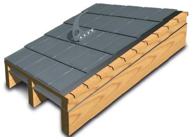
Schema des Dachaufbaus mit Einbauteil Dachhaken
